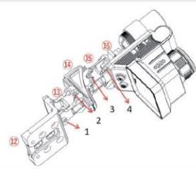
1. Полностью натяните лук и посмотрите на термографию через глазок. С помощью шестигранного ключа на 1/8 дюйма отрегулируйте горизонтальные и вертикальные направляющие так, чтобы глазок был совмещен с рамкой глазка, а основание лука - с центром термографического дисплея;
